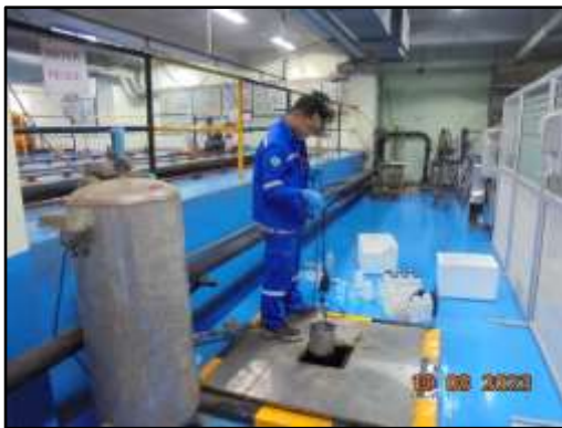
รูปที่ 3.2-2 จุดตรวจวัดคุณภาพน้ำทิ้ง บริเวณบ่อระบายน้ำทิ้ง (Effluent Chamber)
